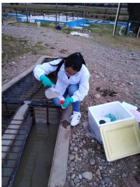
Toma de muestras de agua residual en el afluente del desarenador.
