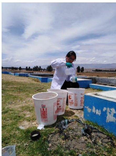
Toma de muestra para el parámetro de coliformes termotolerantes.
