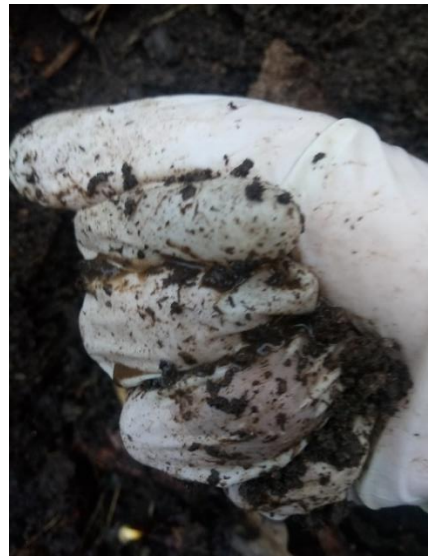
Fotografía 33. Control de humedad con la prueba del puño
