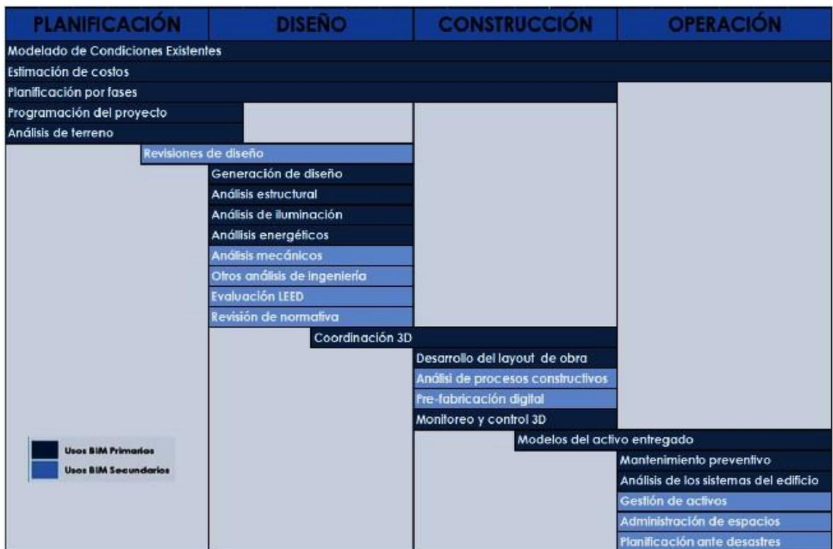
Figura 3. Usos BIM según Computer Integrated Construction (CIC)
