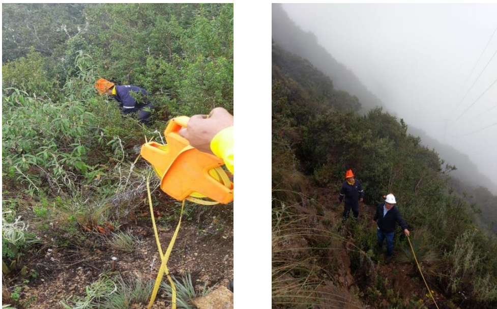
Figura 66. Medición con el método de caída de potencial distancia D1= 62 m y D2=100 m
