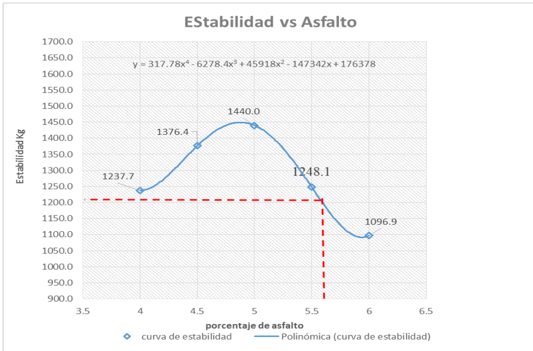
Figura N° 158 Curva de estabilidad con 8% de óxido de cromo Chromafer
