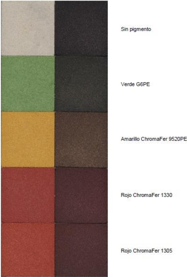
Figura N° 9 Comparativo de pigmentación con cemento asfáltico PEN 85-100 y ligante sintético claro
