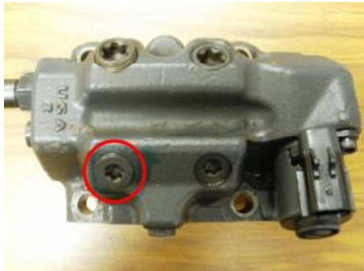
Figura 2. Rotura del cabezal de la bomba.
