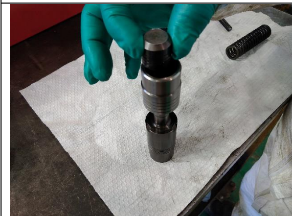
Figura 44. Mal montaje de Válvula.
