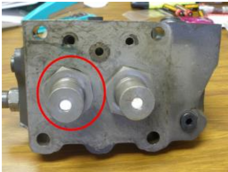
Figura 3. Parte interna dañada de la bomba de combustible.
