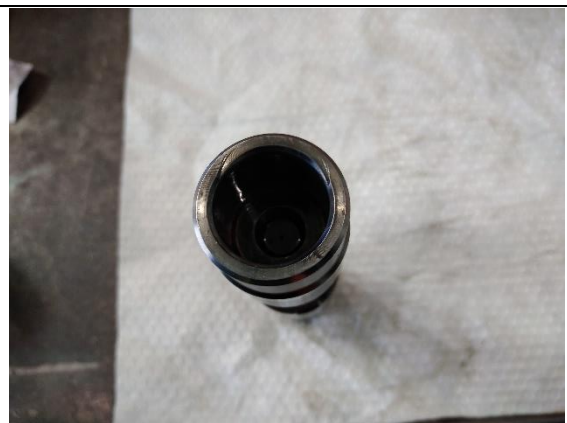
Figura 45. Desgaste en Base de válvula.
