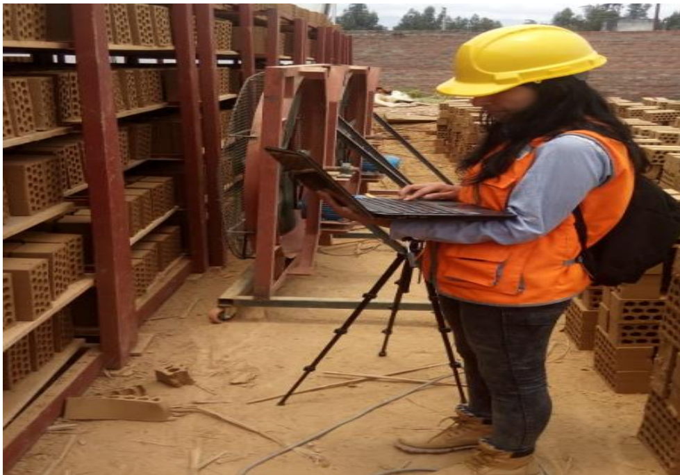
Figura 6: Medición de Ruido - Ventilador 1
