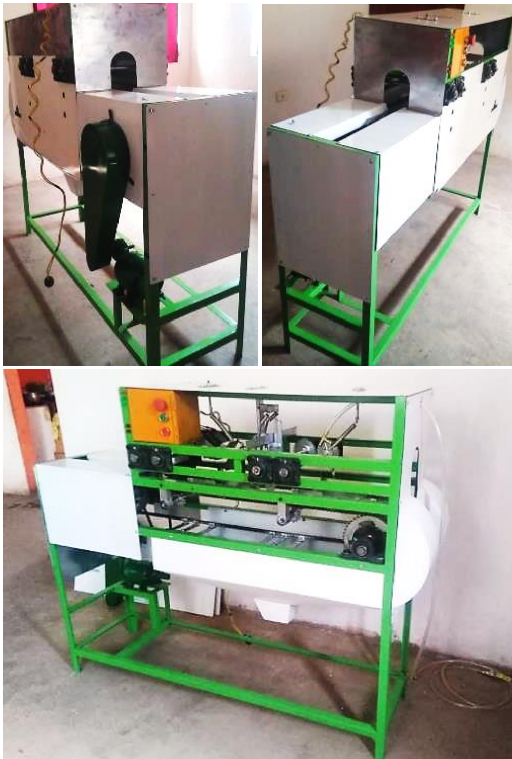
Figura 121. Prototipo máquina evisceradora de truchas
