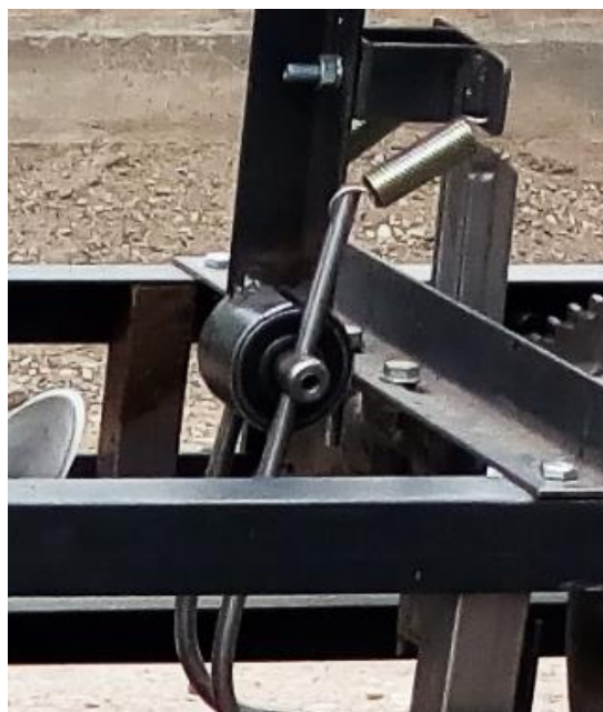
Figura 114. Elaboración del soporte de cuchilla
