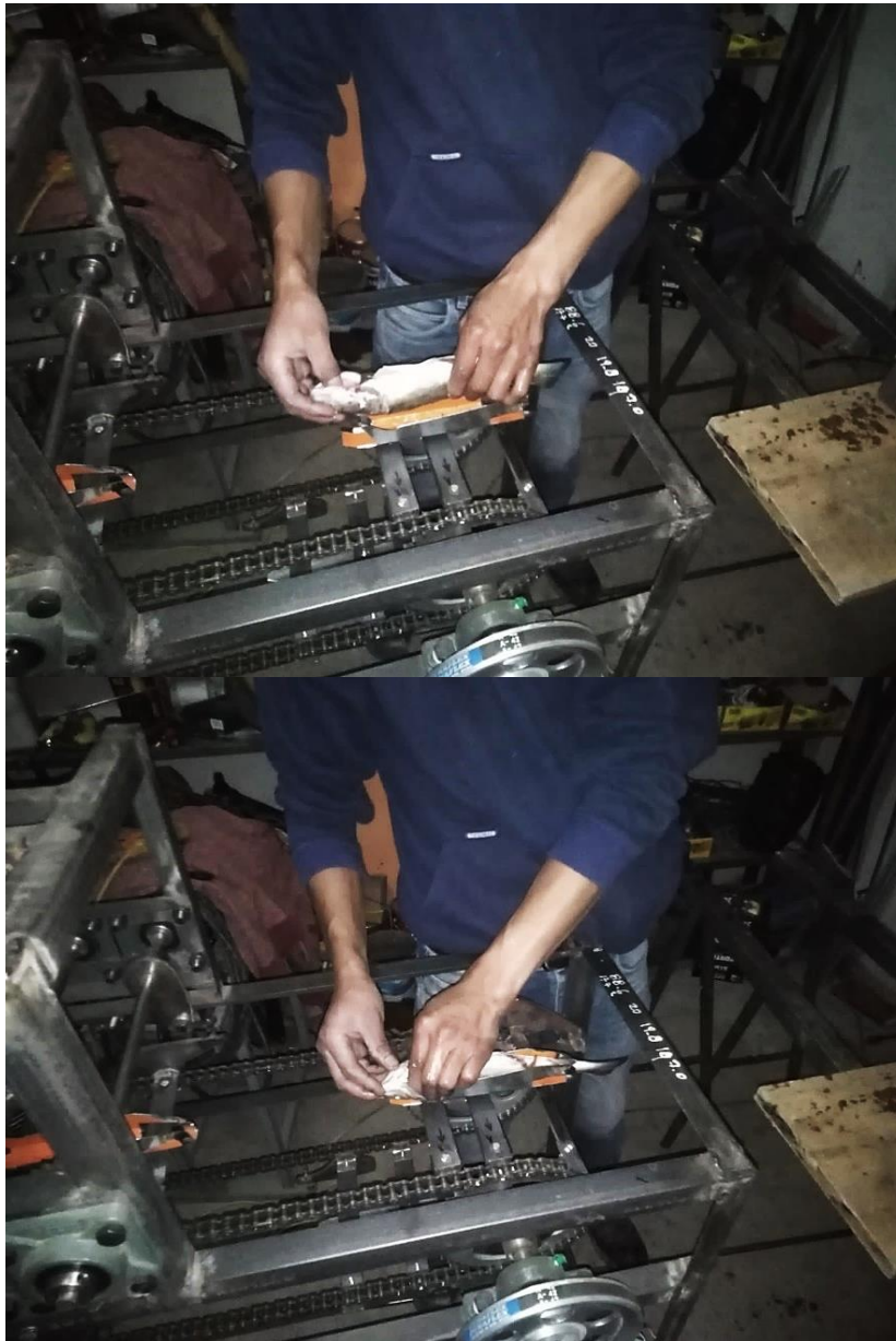
Figura 126. Acomodamiento de las truchas en los cangilones
