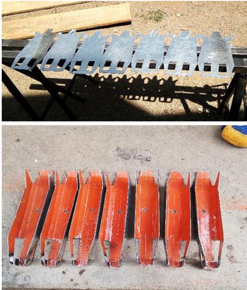
Figura 110. Elaboración de cangilones de tipo con aletas
