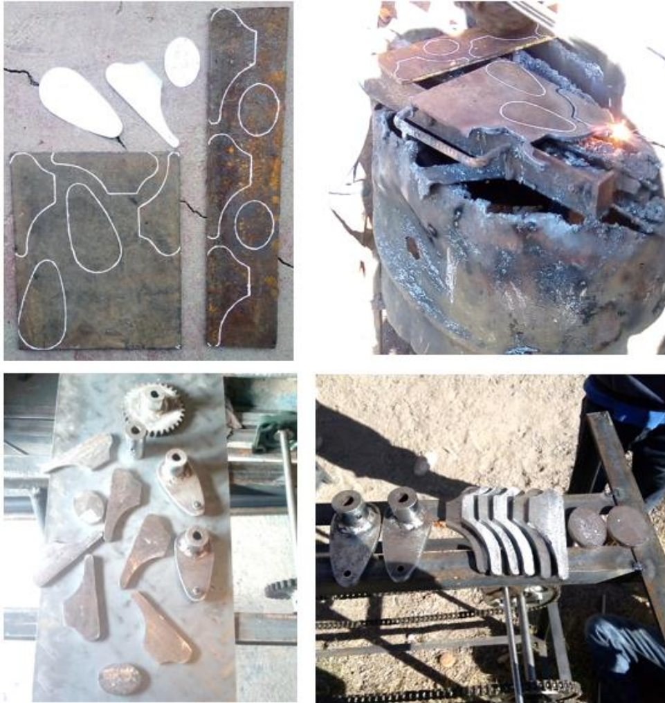
Figura 108. Elaboración de mecanismos de levas
