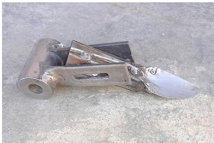
Figura 116. Elaboración del soporte brazo y la cuchara
