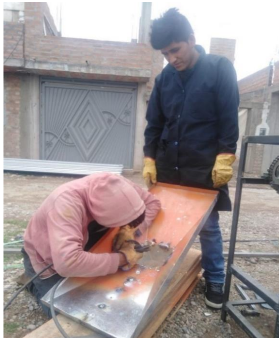
Foto 2: Construcción de la tolva de vísceras
