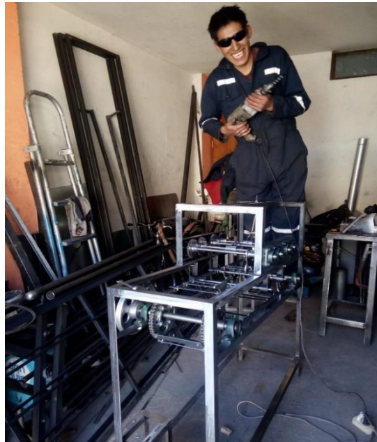
Foto 1: Taladrado de agujeros en la estructura
