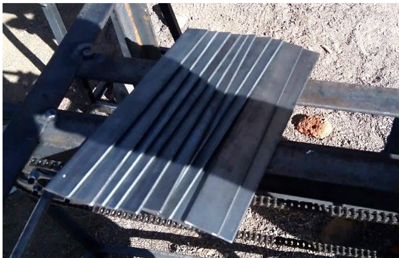
Figura 107. Elaboración de platinas soportes del cangilón
