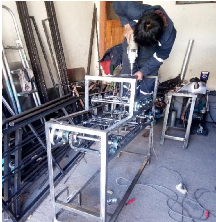
Figura 105. Taladrado de agujeros en la estructura
