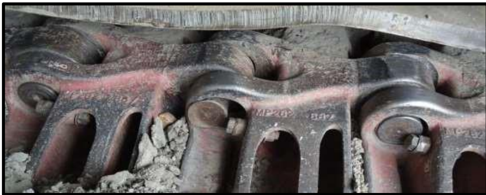
Figura 9. Acumulación de material en zapatas de Pala Fuente: Fotografía propia.
