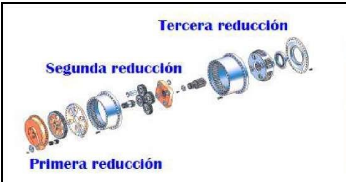
Figura 8. Reductores de giro palas eléctrica Fuente: Equipmet Training Solutions (2013)
