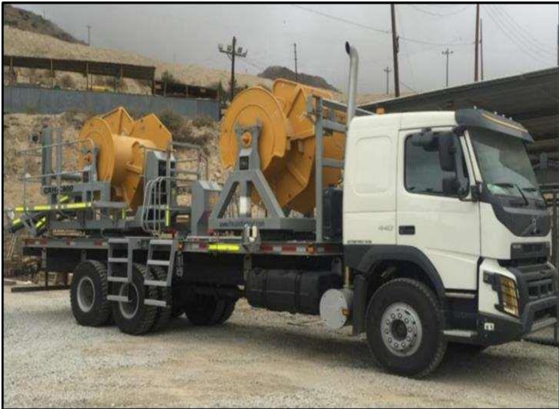
Figura 15. Camión cableero Fuente: Fotografía propia.
