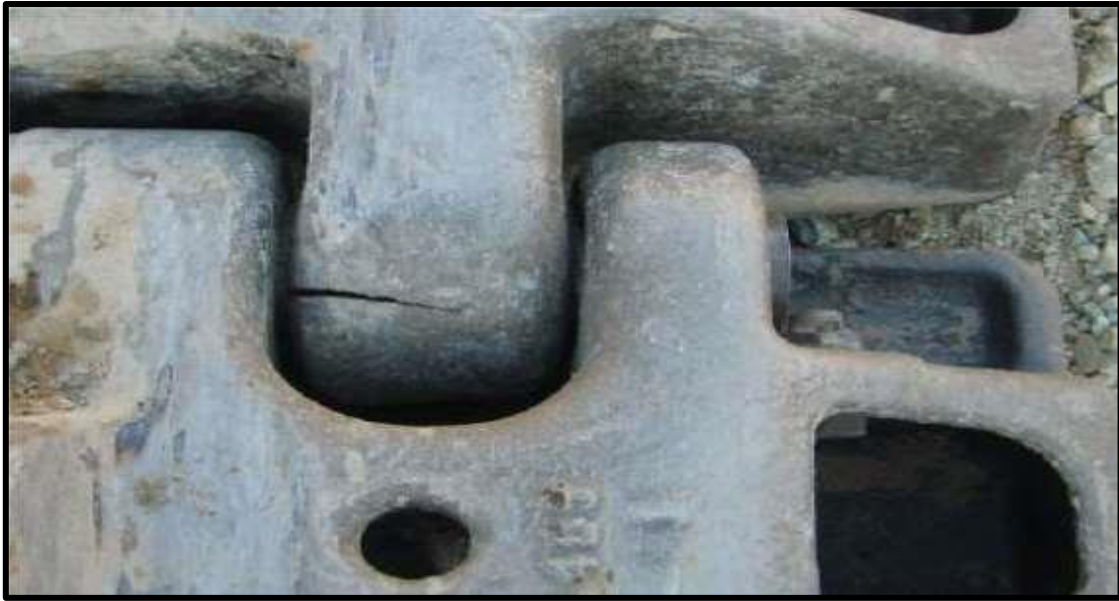
Figura 10. Componente de oruga rajada Fuente: Fotografía propia
