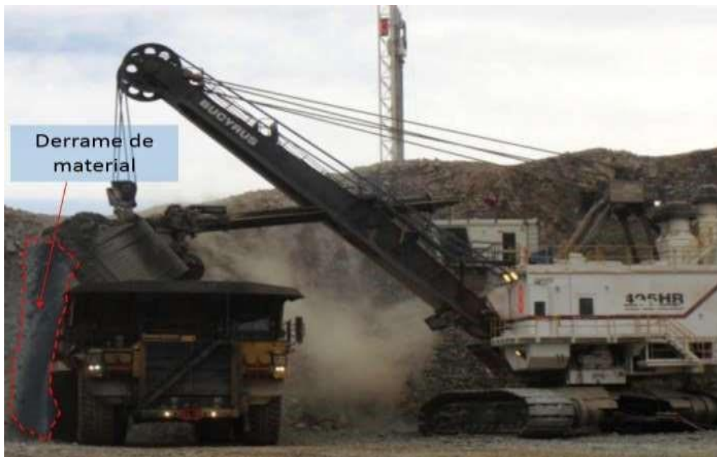
Figura 34: Derrame de material en zona de carguío
