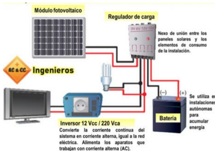
Figura 49. Instalación solar fotovoltaica Fuente: AC & CC Ingenieros (54)
