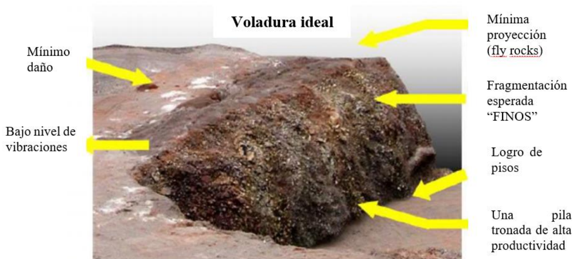
Figura 8. Características de una voladura ideal Fuente: Suasaca, 2014
