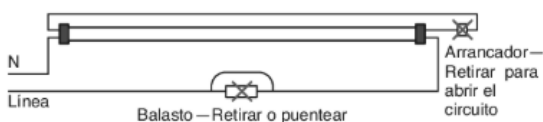
FIGURA 23.5.4.1.3(b) Ejemplo para retirar el balasto y el arrancador, y adaptar el cableado para conectar lámparas de LED en una luminaria.
