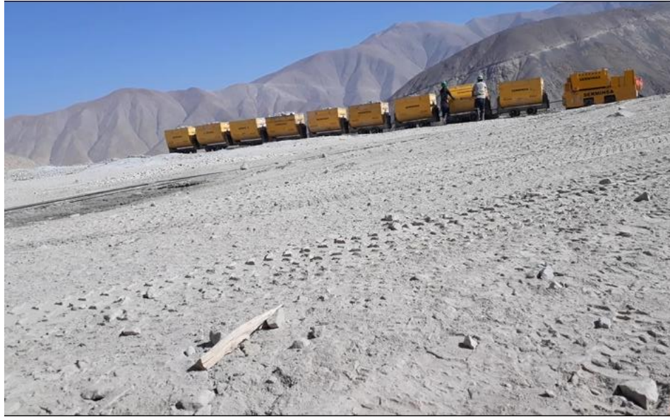
Ilustración 11: Extracción a superficie con locomotora a batería
