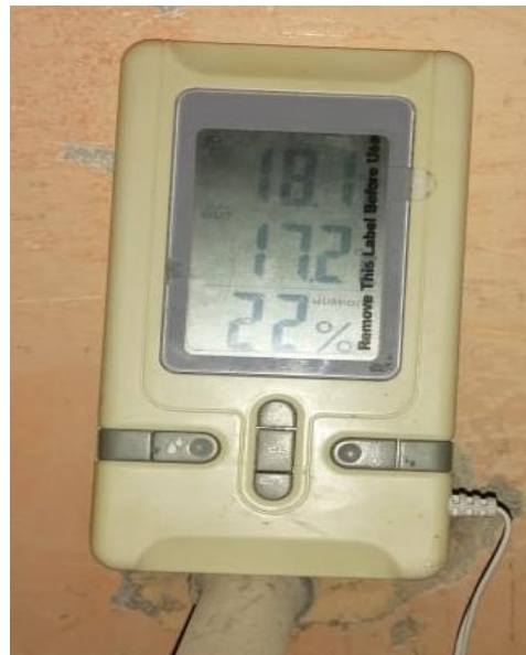
Termohigrómetro: Instrumento para la medición de la humedad y temperatura interna y externa.
