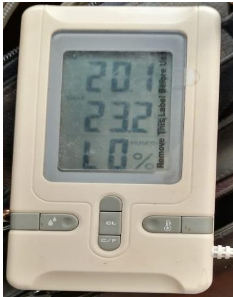
Termohigrómetro: Instrumento para la medición de la humedad y temperatura interna y externa.
