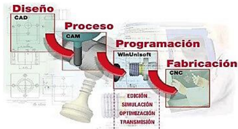
Imagen 17. Secuencia de proceso de operación en un control numérico computarizado
