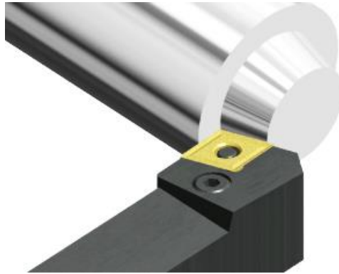
Imagen 3. Proceso de refrentado
