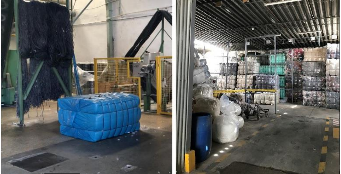
Figura 16. Enfardado de fibra regenerada y almacenamiento. Elaboración propia
