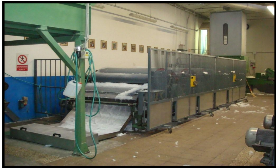
Figura 21. Maquina Garnett en pleno proceso de trituración
