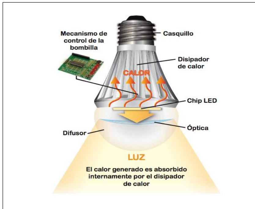
Ilustración 12: Características de una luminaria LED
