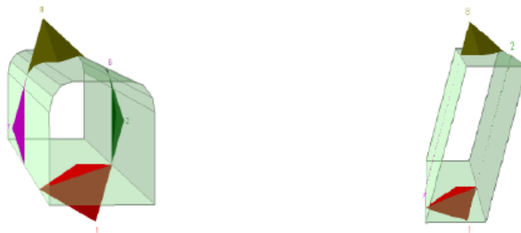
Cuñas formadas en labores de avance
