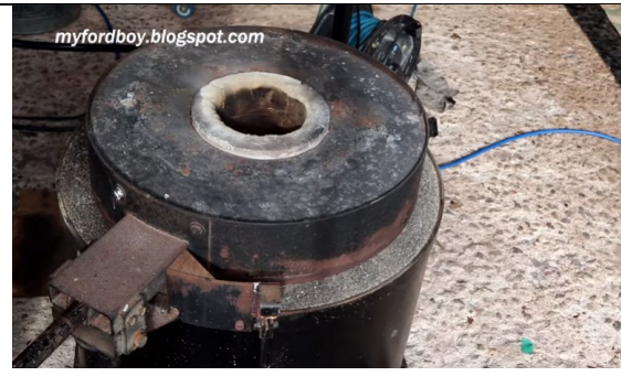
Cerrar el horno hasta que se funda la materia prima
