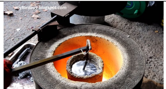
Con el Pirómetro se controla la temperatura
