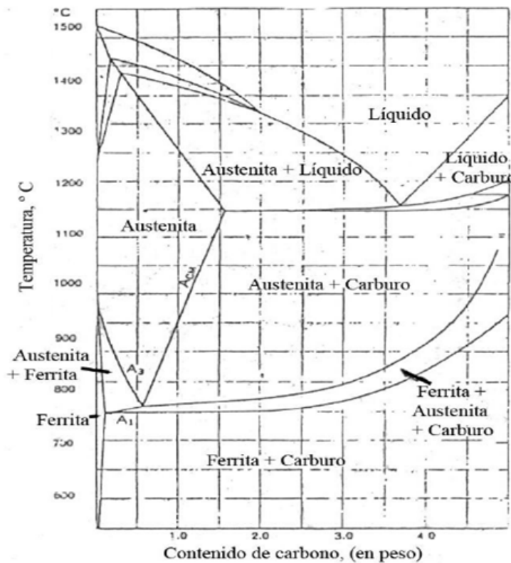
Figura 5.15 Diagrama Fe-C alterado por 2% de Si. Se puede ver la alteración de las composiciones eutécticoide y eutéctica, la solubilidad máxima del carbono en la austenita; así como también eleva las temperaturas de ambas reacciones y estas ocurren ahora dentro de un rango. [22]
