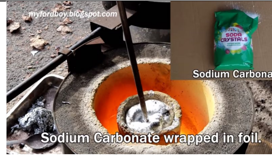
Agregando carbonato de sodio como fundente
