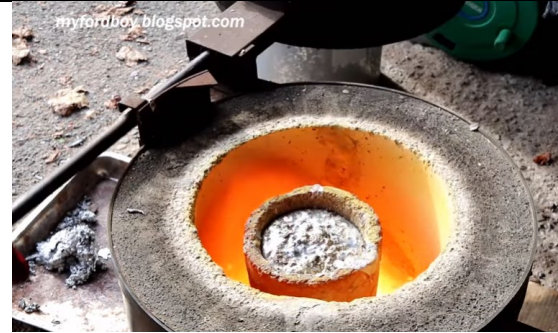
Metal fundido ahora se procede a retirar la escoria
