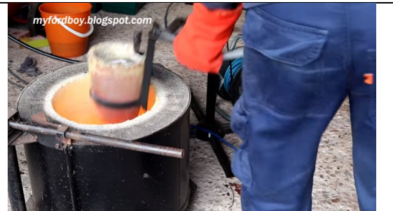
Se retira del horno para realizar el método por colada
