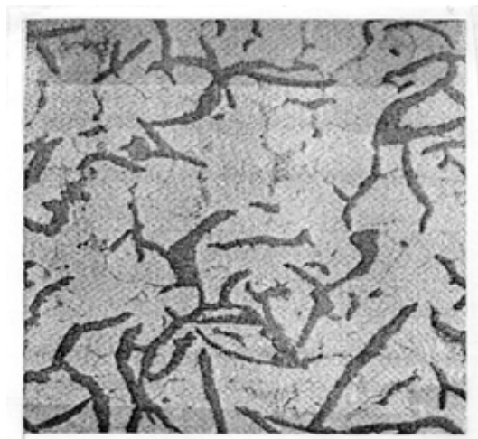
Figura 5.21 Microestructura fundición gris. Hilos de grafito sobre una matriz de ferrita [2]
