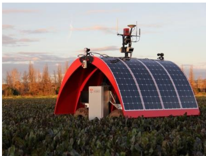
Figura 7. Robot fumigador Ladybird Fuente: Universidad de Sydney
