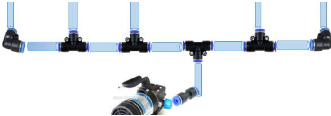
Figura 132. Distribución y conexión de los racores para las 5 boquillas de aspersores Fuente: elaboración propia
