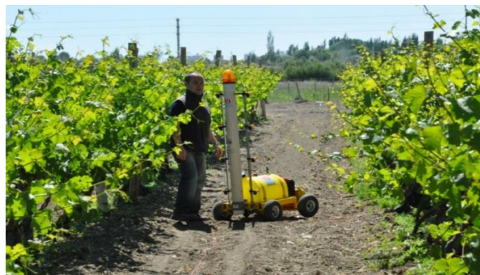
Figura 2. Robot ThakÛr fumigando un terreno de cultivo Fuente: Robot ThakÛr- Instituto Nacional de Tecnología Agropecuaria
