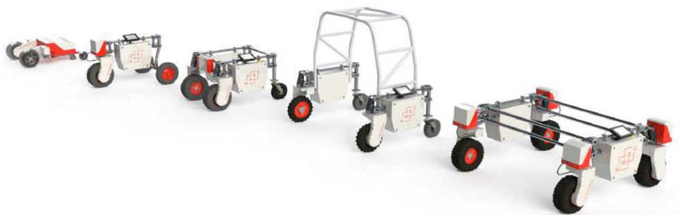
Figura 10. Configuraciones del robot Thorvald II Fuente: The Thorvald II Agricultural Robotic System
