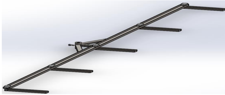
Figura 116. Sistema mecánico de aspersión completo Fuente: elaboración propia
