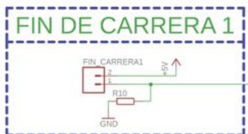
Figura 187. Diagrama esquemático del final de carrera Fuente: elaboración propia
