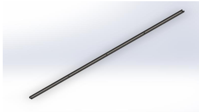
Figura 74. Platina en forma de U para sistema de aspersión Fuente: elaboración propia
