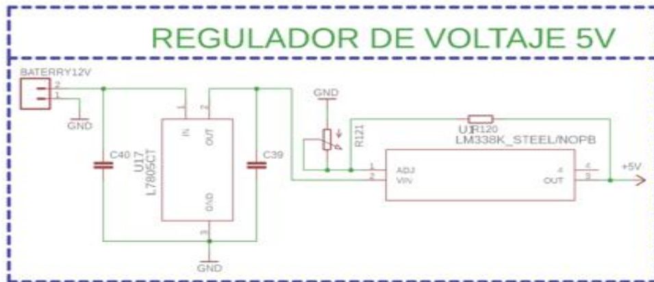
Figura 153. Circuito regulador de voltaje de 12V 5 V Fuente: elaboración propia
