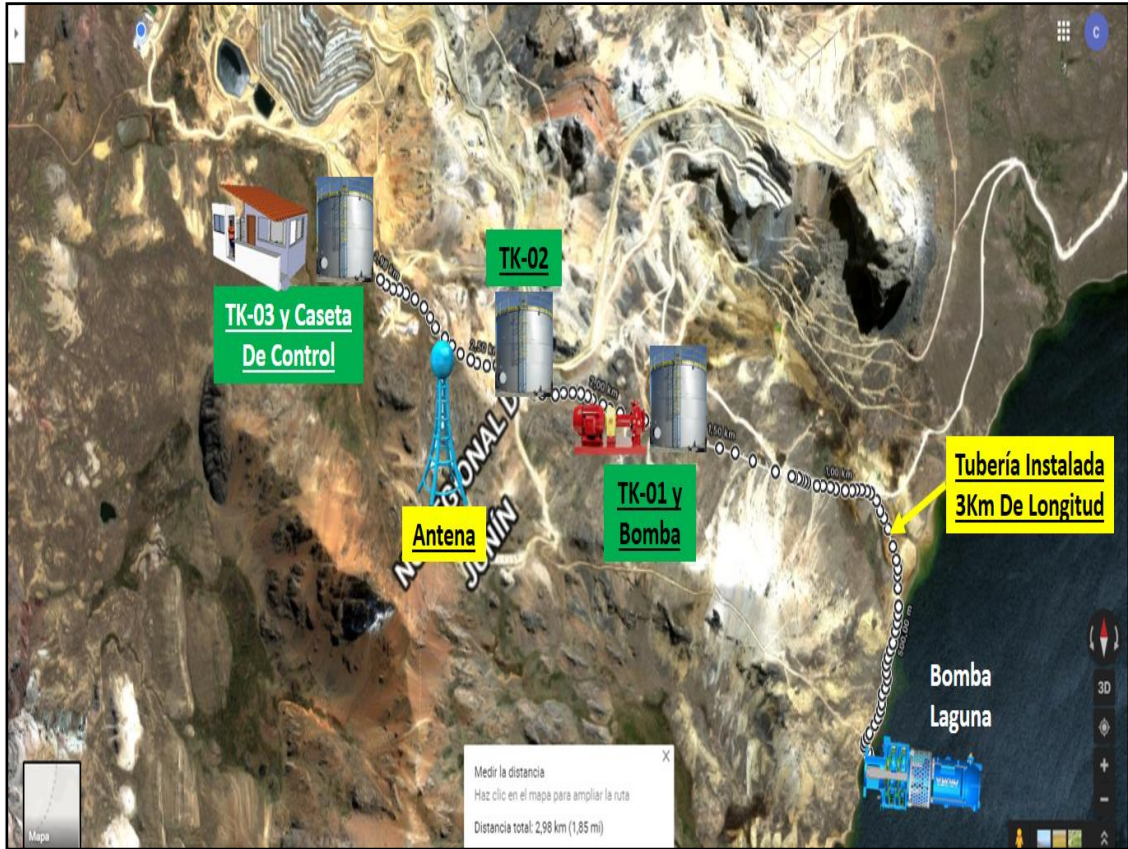
Figura 29. Secuencia de bombeo desde laguna hasta el tanque 3 Fuente: elaboración propia
