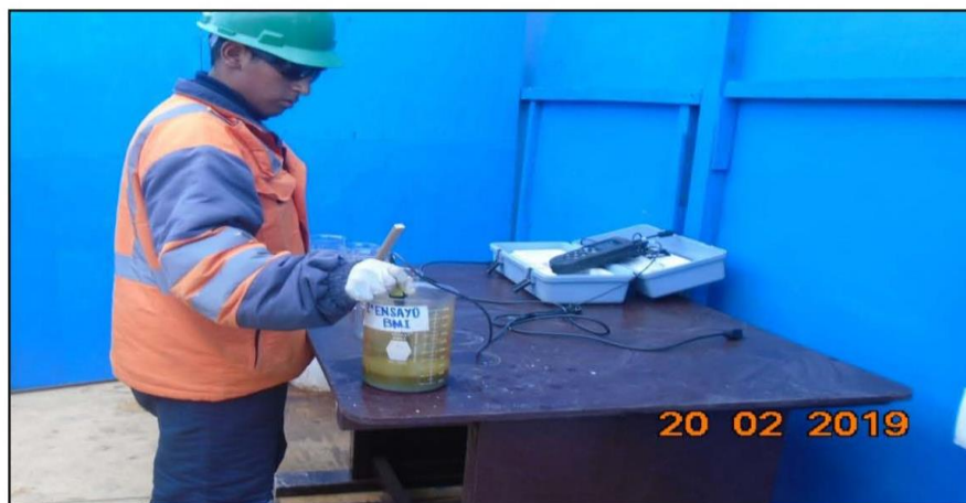
Imagen 07: Medición de pH en muestras de cal con el agua acida.
