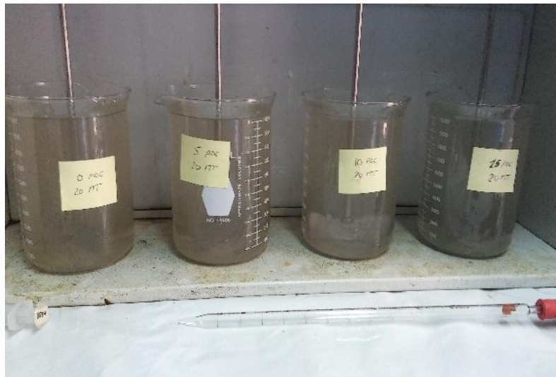
Prueba inicial de la dosificación de floculante y coagulante respecto de la turbidez (3).
