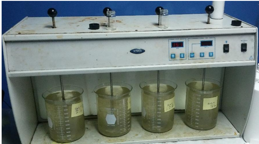
Prueba inicial de la dosificación de floculante y coagulante respecto de la turbidez (5).
