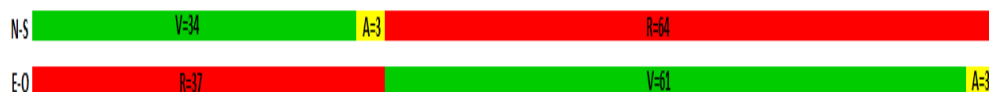
Figura 32: Esquema semaforizado de la Intersección de la Av. San Carlos y el Jr. Huancas
