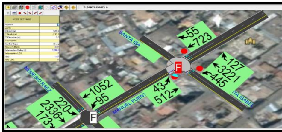
Figura 94: NDS de la intersección I3 al colocar un semáforo en la intersección I2 al año 2029.
