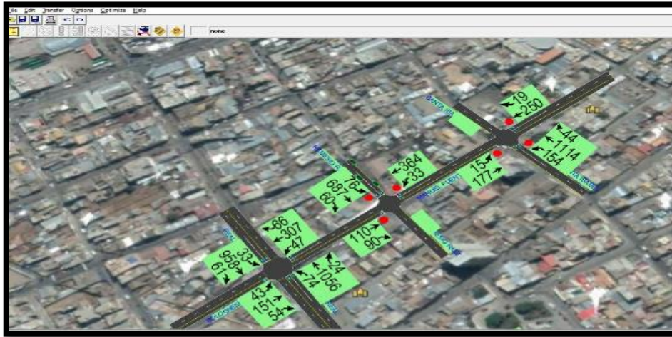
Figura 111: Representación esquemática de volúmenes de las intersecciones estudiadas al colocar una chicana en la intersección I2 del año 2019.
