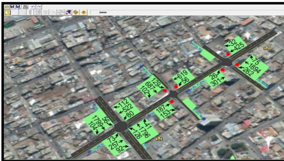
Figura 99: Representación esquemática de volúmenes de las intersecciones estudiadas al colocar un reductor de carril en la intersección I2 al año 2024.
