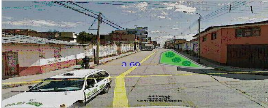
Figura 97: Método estrechamiento en la intersección I2.
