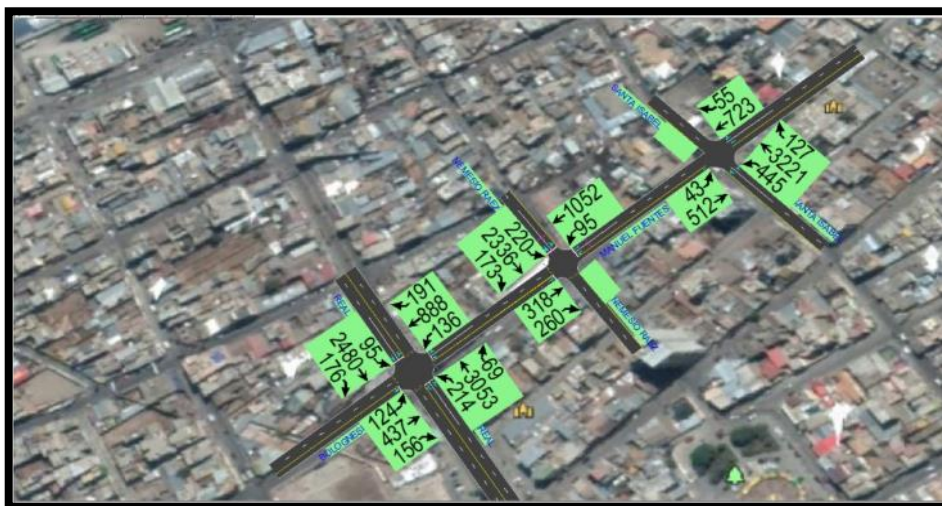
Figura 87: Representación esquemática de volúmenes de las intersecciones estudiadas al colocar un semáforo en la intersección I2 al año 2029.
