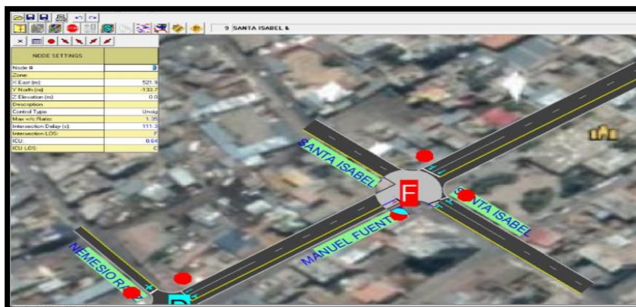
Figura 101: NDS de la intersección I3 al colocar el método de estrechamiento de carril en la intersección I2 del año 2019.
