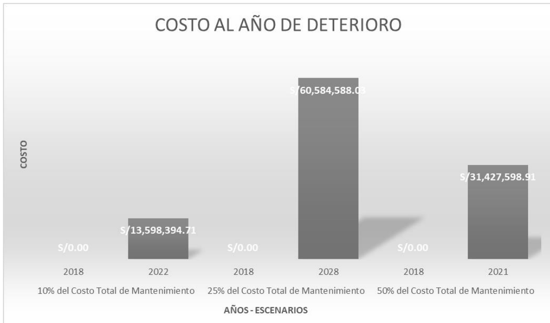
Figura 61. Costo del mantenimiento del pavimento al año de deterioro con probabilidad a 10 años
