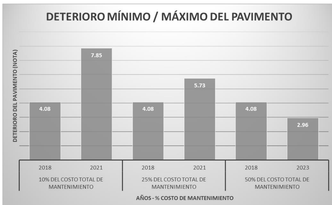
Figura 54. Consolidado de deterioro del pavimento con la probabilidad a 5 años
