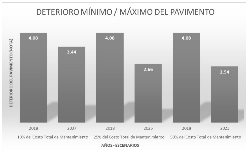
Figura 72. Consolidado de deterioro del pavimento con la probabilidad a 20 años
