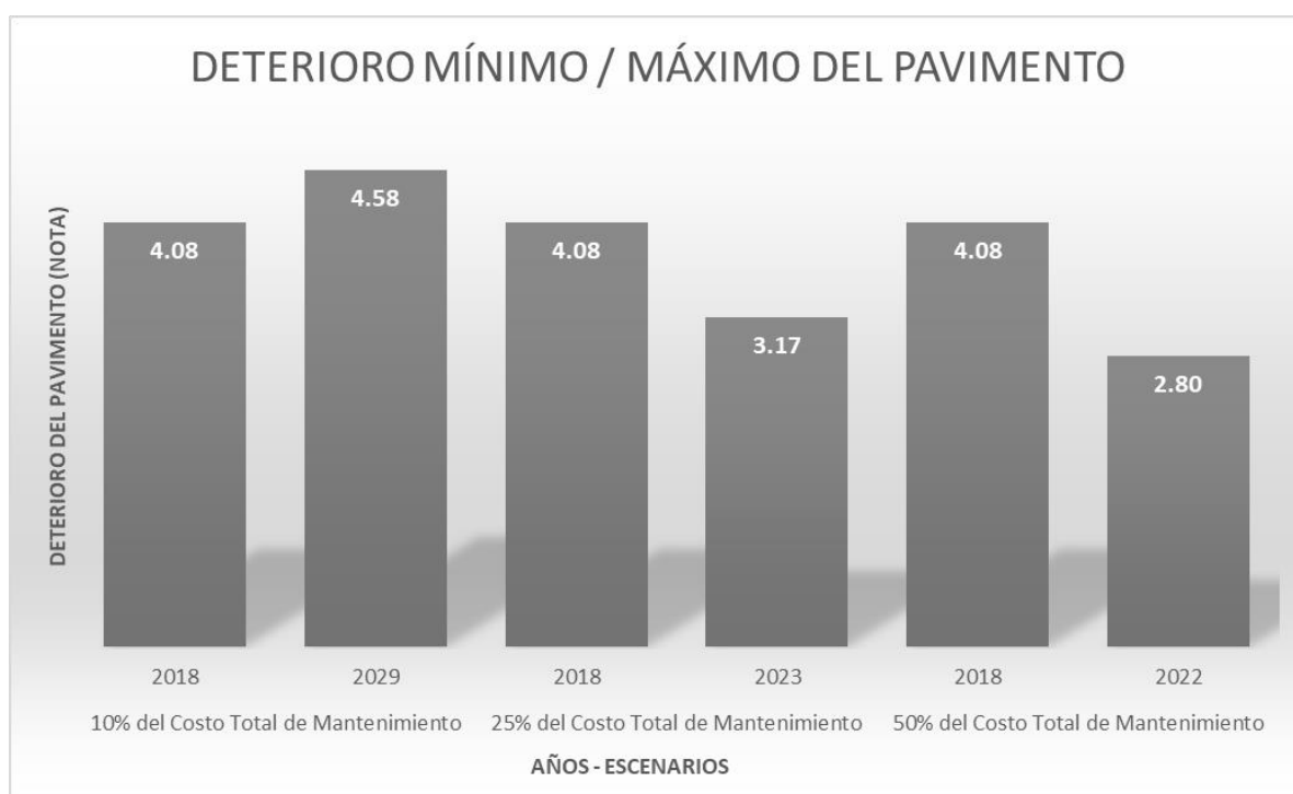
Figura 66. Consolidado de deterioro del pavimento con la probabilidad a 15 años
