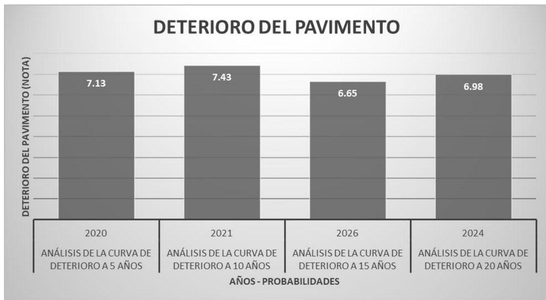
Figura 47. Consolidado de deterioro del pavimento sin mantenimiento en los 4 escenarios
