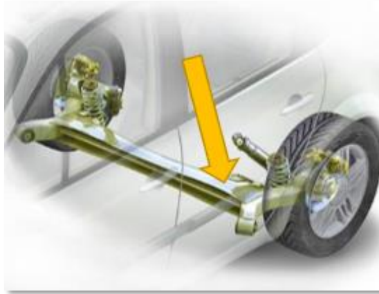
Figura 25. Instalación de dispositivo de aceleración vertical
