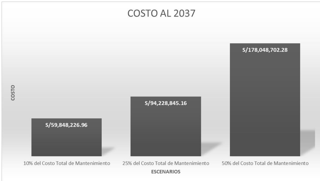
Figura 68. Costo de los mantenimientos del pavimento al 2037 con la probabilidad a 15 años
