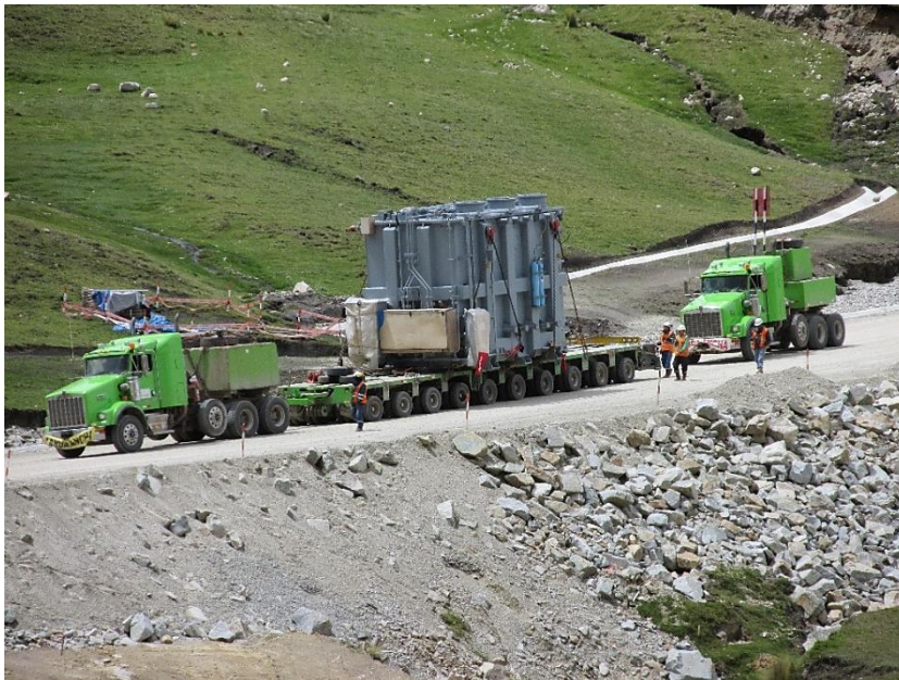
Figura 9: Transporte de transformador de potencia
