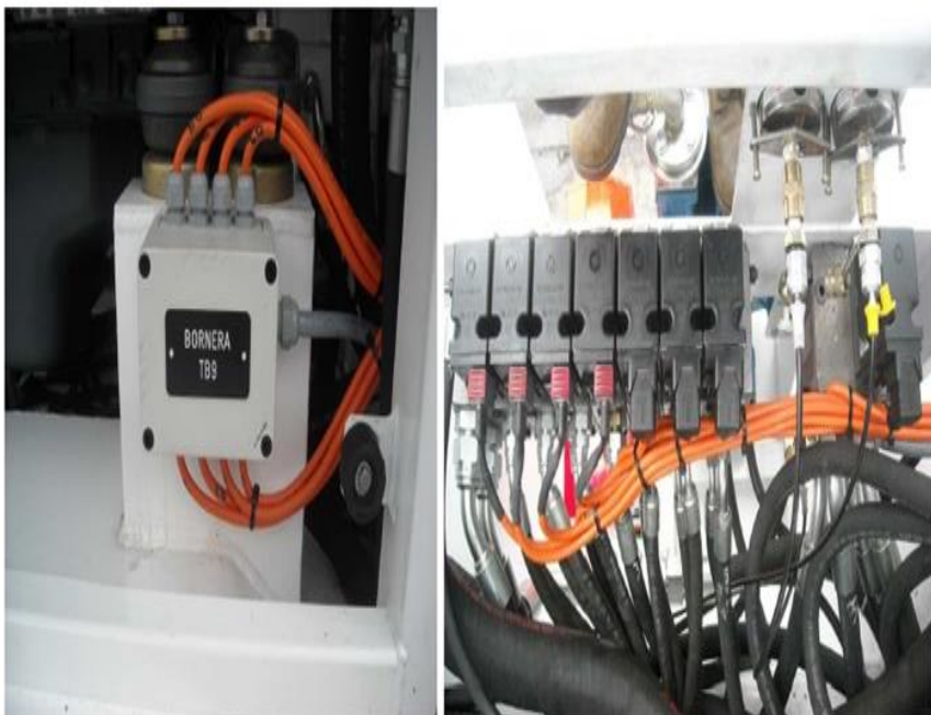
Figura 67. Bornera TB 9 electroválvulas de control de movimiento de brazo.
