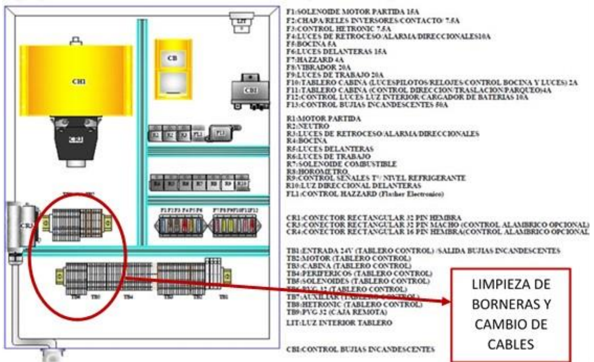
Figura 65. Guía rápida eléctrica de Robot Alpha 20.
