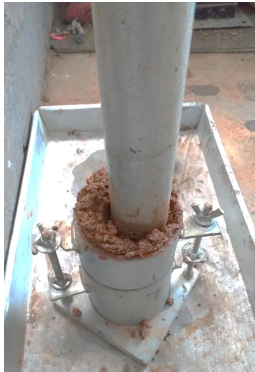
Ensayo de compactación con 10% de Humedad
