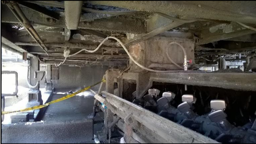
Figura 16. Punto de descarga de la línea de aditivo en el mezclador continuo de Planta.
