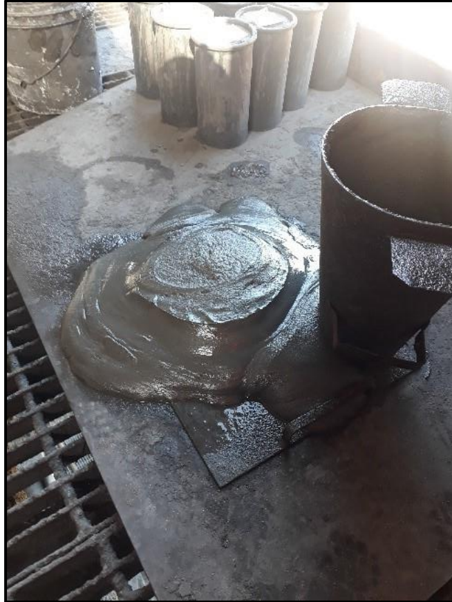
Figura 13. Prueba de slump de la pasta.
