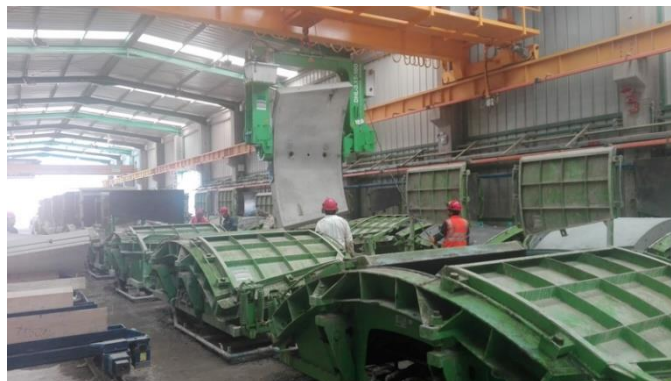
Figura N° 16: Volteo de dovela. Fuente: Propia.
