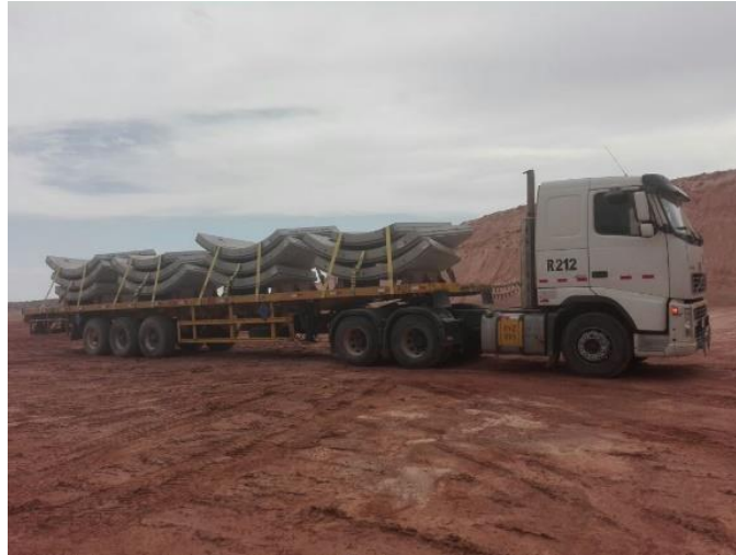
Figura N° 19: Transporte de dovelas al proyecto. Fuente: Propia.
