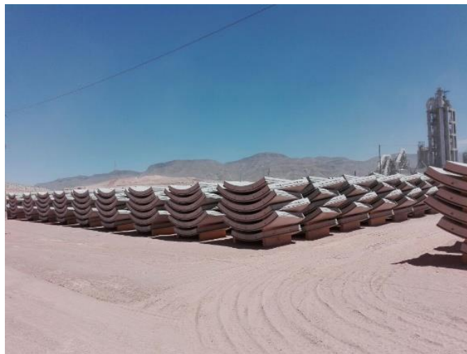
Figura N° 18: Acopio de dovelas en fabrica. Fuente: Propia.
