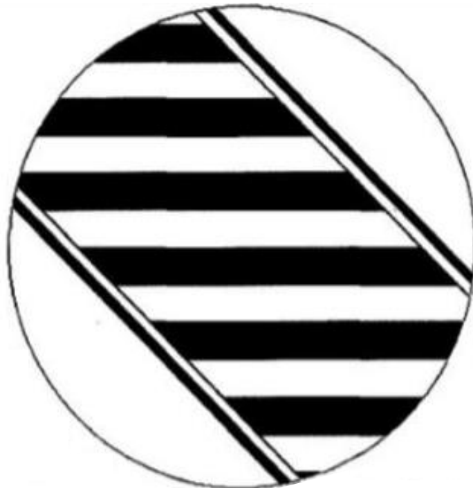
Figura N° 62: Banda de goma delimitante en cruce peatonal
