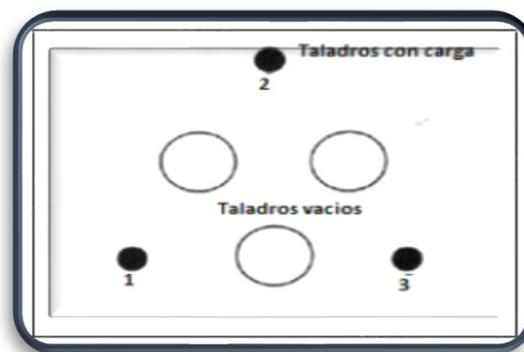
**Figura 2** Arranque cilíndrico modificado por Hagan, fuente: Manual de perforación y voladura-López Jimeno
