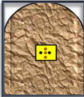
**Figura 26** Posición de corte en el frente, fuente internet
