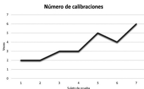
Figura 31. Número de calibraciones realizadas para obtener una señal sEMG manipulable en el método 1.
