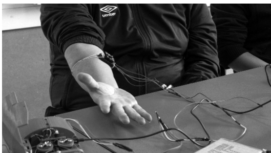
Figura 12. Sensor en la superficie del músculo flexor común superficial de los dedos.
