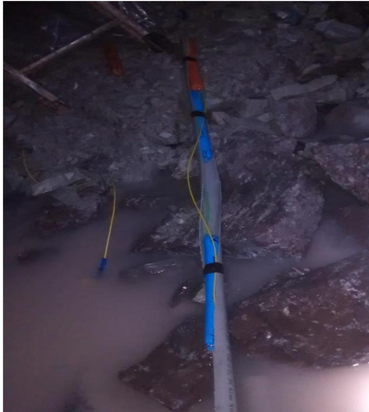
Producto elaborado con tubería de PVC partido de la mitad y relleno de material explosivo más pentacord para uso exclusivo en los contornos de la labor, el resultado de ello es netamente para control de sobre rotura y sobre excavación.
