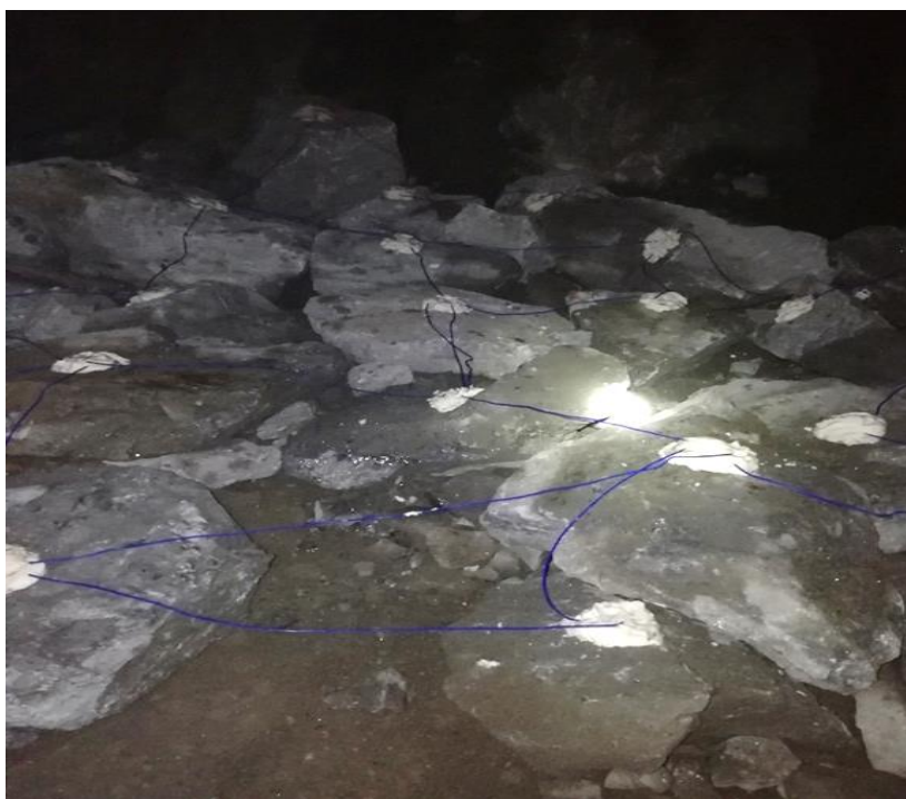
Figura 38: Plasteo de bancos superiores a 40cm x 40cm en cámara de plasteo
