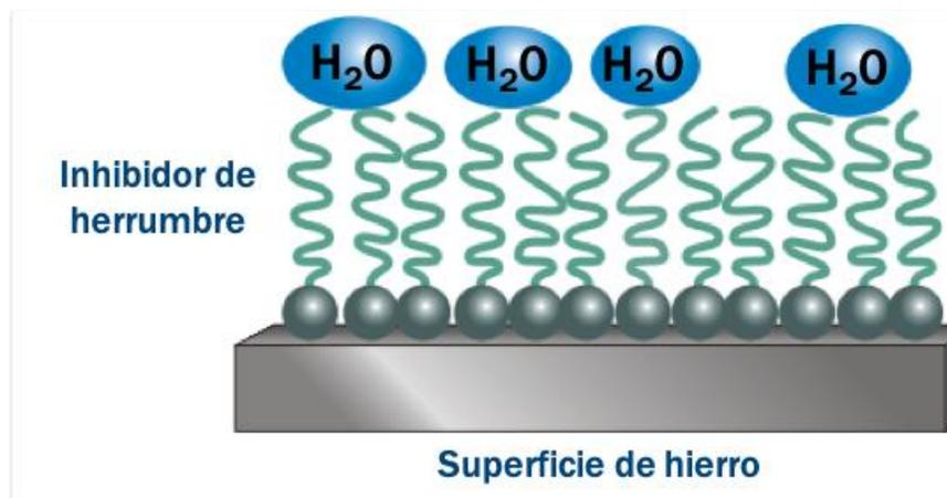
Figura 7 Cómo trabajan los inhibidores de corrosión
