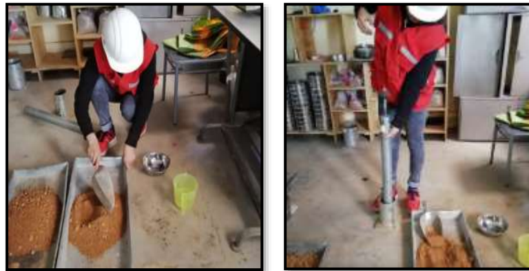
Figura 26: Mezclado de muestras con contenidos de agua y Compactado.
