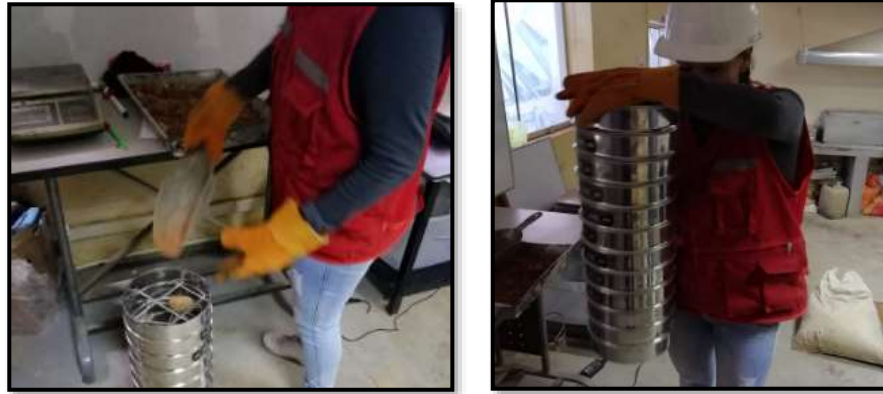
Figura 20: Tamizado de la muestra representativa.
