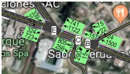
Figura 135. NDS al 2028 con desarrollo + (primera, segunda y tercera) alternativa desarrollada en la Av. Palian-Jr. Ciro Alegría
