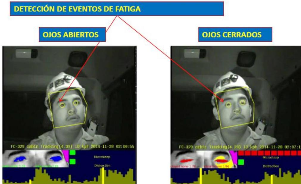
**Fig. 2 - Detección de eventos de fatiga por medio del sensor Óptico**
