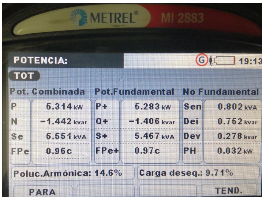
Figura 21: Potencia activa, reactiva, aparente y factor de potencia Fuente: elaboración propia
