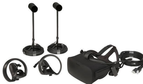
Figura 58. Componentes del "Oculus Rift with Touch VR system" Fuente: PXVR (103)
