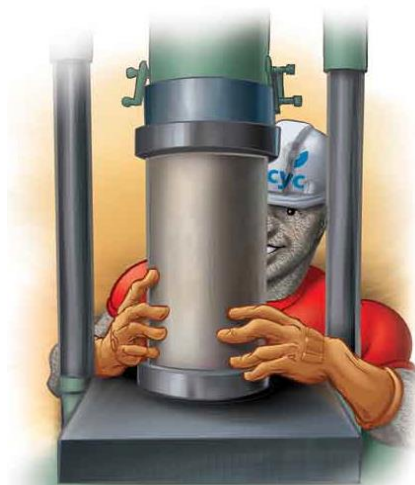
Figura 3: Colocado de la Probeta a Ensayar.
