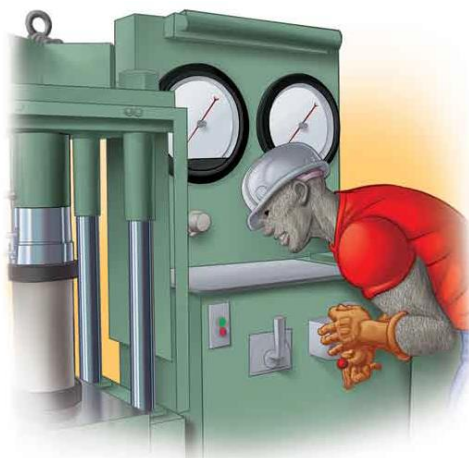
Figura 4: Aplicación de la Carga a Velocidad Uniforme.
