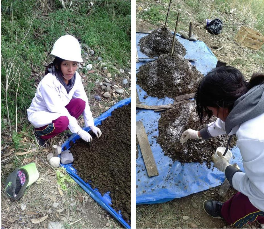
Fotografías 04 y 05. Preparación de las pilas y estandarización del pH con cal.
