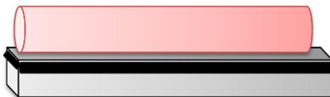
Figura 19. Esquema de base de concreto para tuberías. Tomado de “Preparación de concreto para colocar inserto de HDPE-Trabajos en horario extendido y/o nocturno- Documento PL08-1000-Q4-B-055”, por INMAC, 2018.
