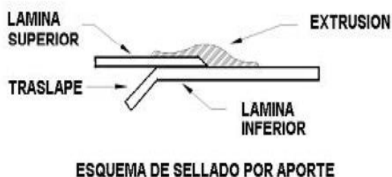
Figura 21. Soldeo de geomembrana con extrusora. Tomado de “Preparación de concreto para colocar inserto de HDPE-Trabajos en horario extendido y/o nocturno- Documento PL08-1000-Q4-B-055”, por I.
