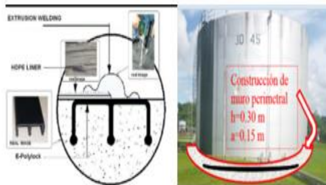
Figura 16. Esquema de sardinel perimetral en tanques
