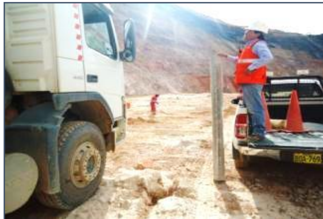
Figura 42: Análisis para medir el esponjamiento tubo de 6 pulg
