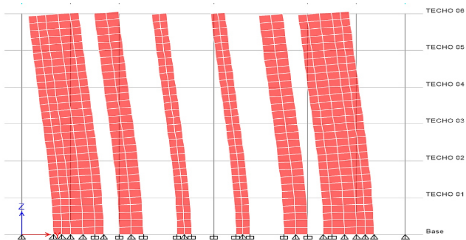
Figura 57: Primer modo de Vibración (ETABS) - Bloque 1
