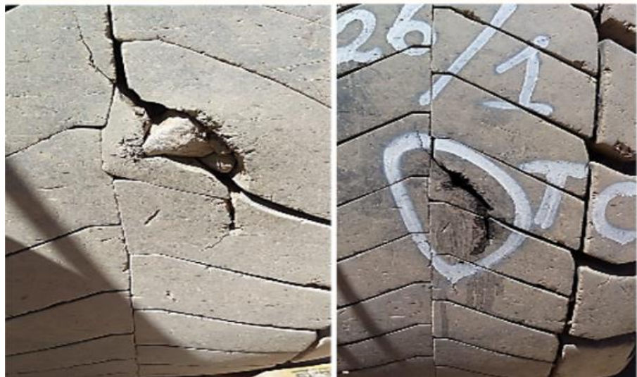
Figura 31. Daños ocasionados por incursión de rocas. Tomado de Dispatch Versión 2 [software de computadora], por Modular Mining Systems Sociedad Comercial de Responsabilidad Limitada | Mms S.R.L., Tucson, Estados Unidos.
