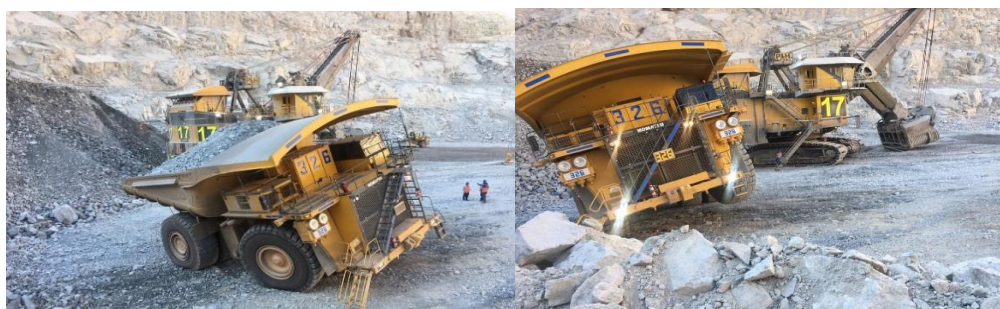
Figura 27. Incidente por inestabilidad de camión
