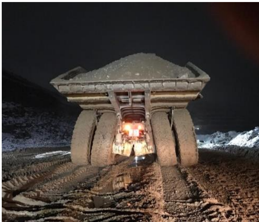
Figura 28. Rotura de diferencial de camión
