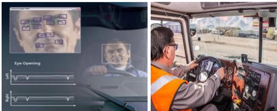
Figura 4. Sistema detector de somnolencia. Tomado de Freeport McMoran, 2014, Lima: SM.
