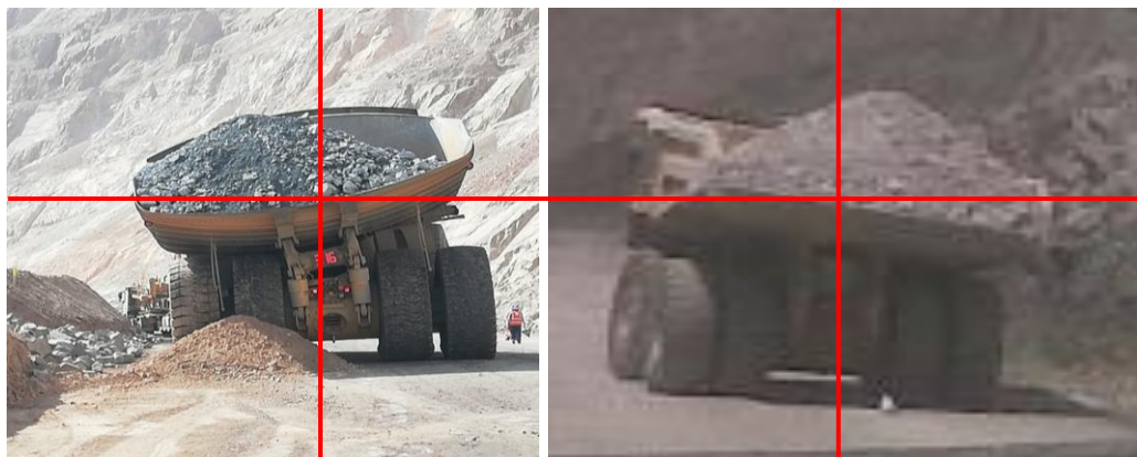
Figura 26. Carga inadecuada en el camión minero
