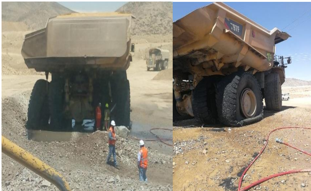
Figura 32. Neumáticos dañados en los camiones mineros. Tomado de Dispatch Versión 2 [software de computadora], por Modular Mining Systems Sociedad Comercial de Responsabilidad Limitada | Mms S.R.L., Tucson, Estados Unidos.
