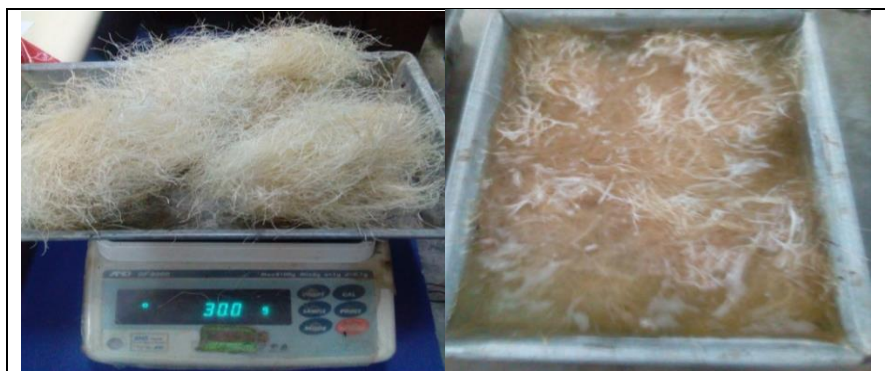
Figura 6: Peso y saturación de la fibra de Agave Americana L
