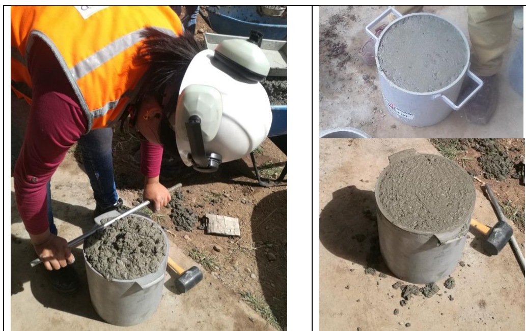
Figura 15: Ensayo de exudación de concreto premezclado con y sin fibra.
