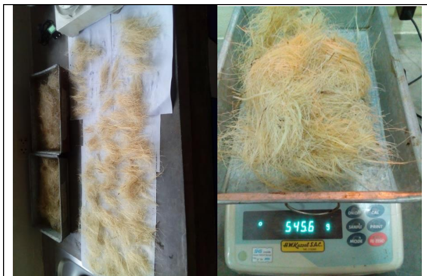
Figura 7: Peso de la muestra de la fibra de Agave Americana L Saturada Superficialmente Seca
