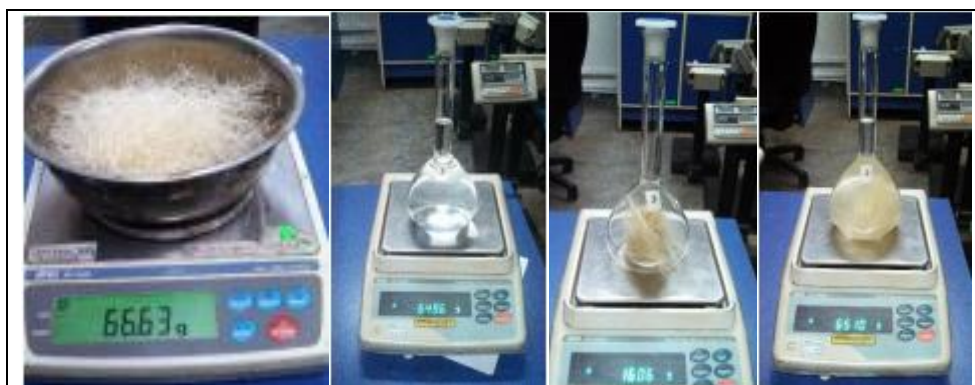
Figura 9: Ensayo de peso específico de la fibra de Agave Americana L
