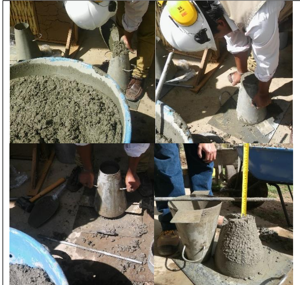
Figura 11: Ensayo de asentamiento del concreto premezclado con y sin fibra.
