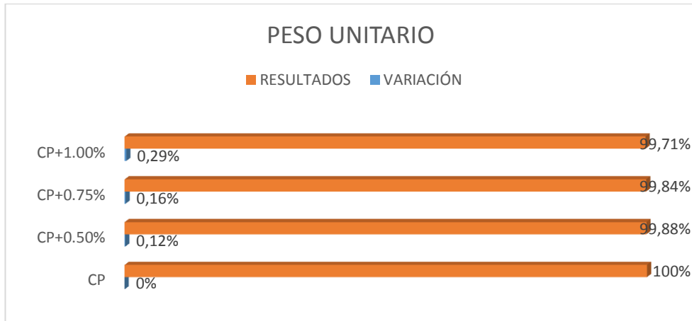
Figura 21: Variación del peso unitario del concreto premezclado f c=280kg/cm2
