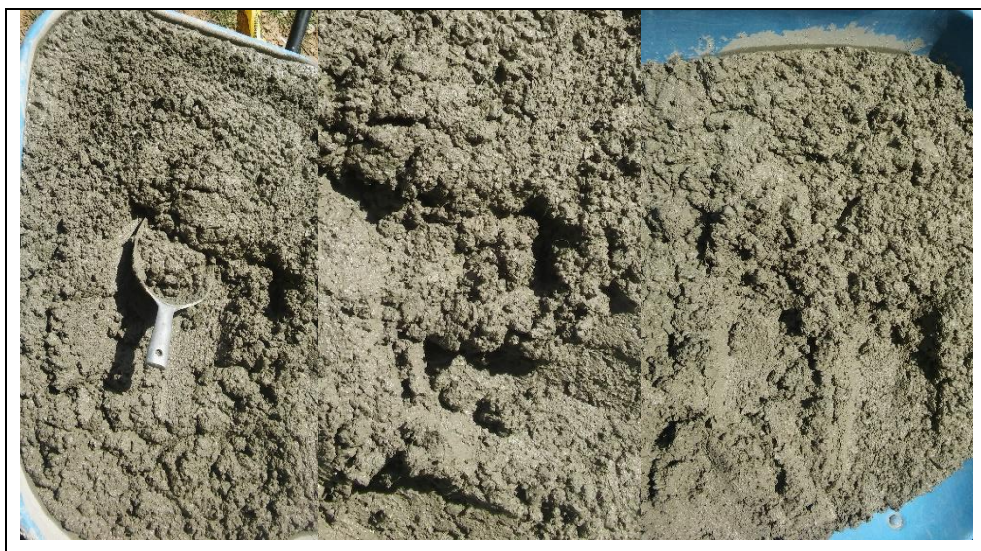
Figura 10: Muestreo del concreto premezclado con y sin fibra.
