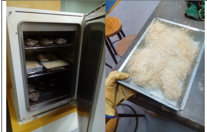
Figura 8: Muestra seca en el horno de la fibra de Agave Americana L
