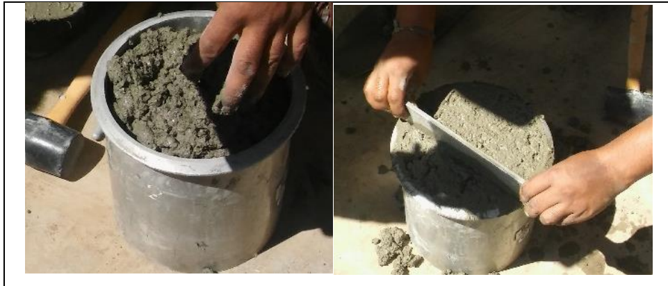
Figura 14: Ensayo de peso unitario de concreto premezclado con y sin fibras.
