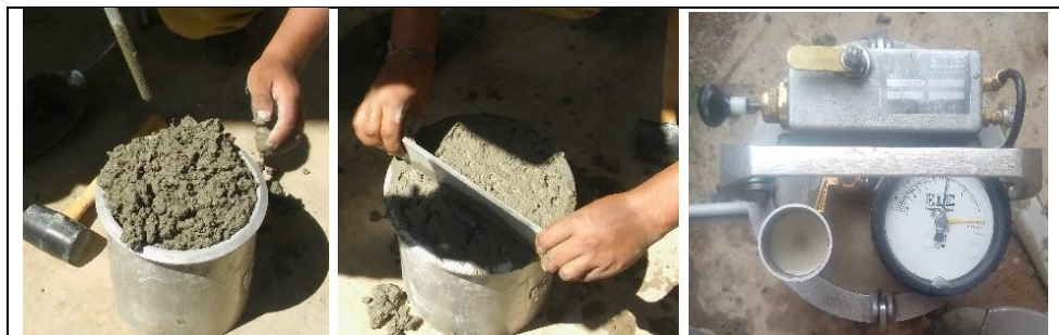
Figura 12: Ensayo de contenido de aire del concreto premezclado con y sin fibra.
