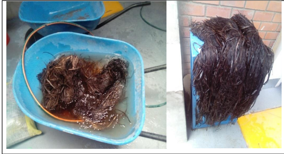
Figura 5: Lavado de la fibra para procesamiento
