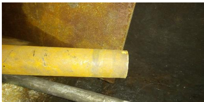
Figura 65. Barra t38-rd38-t38 5´ cortada
