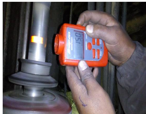
Figura 48. Corrección de los rpm según el estándar
