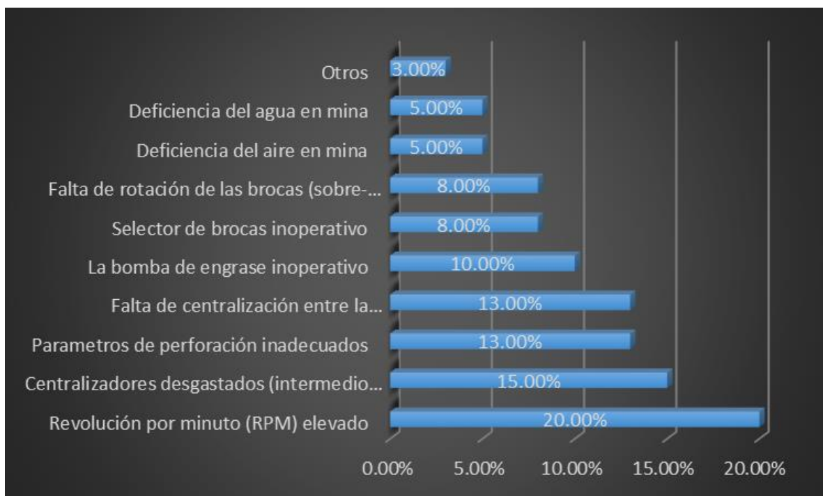
Figura 49. Fallas comunes de los equipos de perforación
