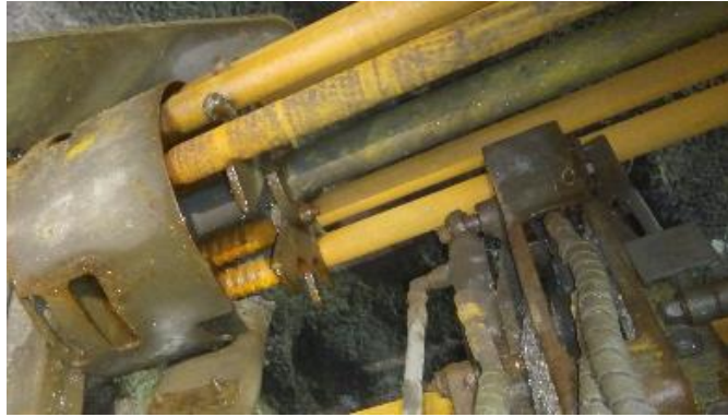
Figura 64. Carrusel del Simba 20 con 8 barras t38-rd38-t38 5´
