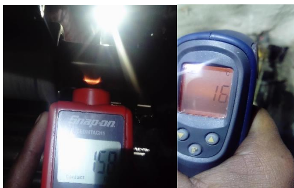
Figura 44. Medición de las rpm y temperatura de la columna
