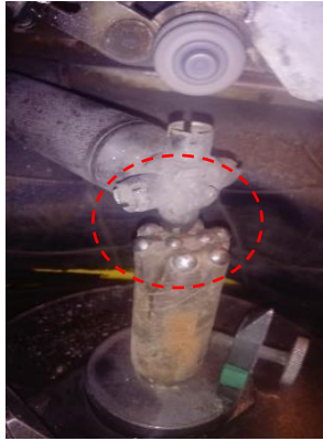
Figura 25. Centralización de la broca
