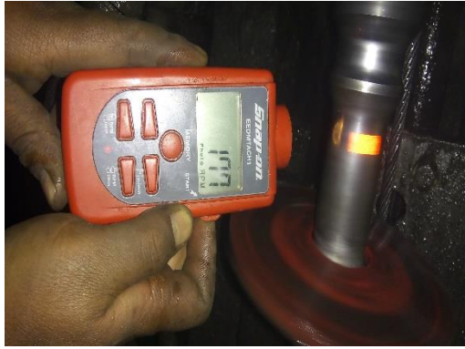
Figura 32. Medición de las rpm.
