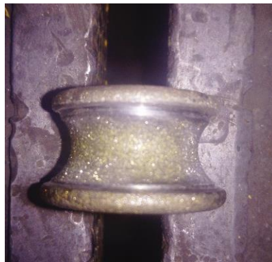
Figura 24. Desgaste prematuro de la muela (afilar sin agua)
