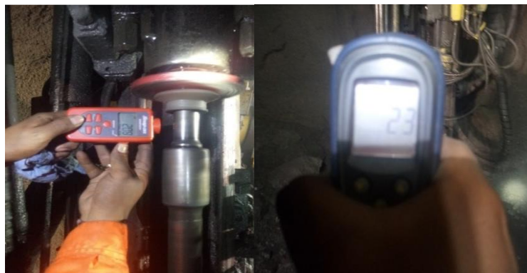
Figura 39. Medición de las RPM y temperatura
