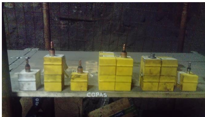
Figura 21. Copas de afilado y devastado
