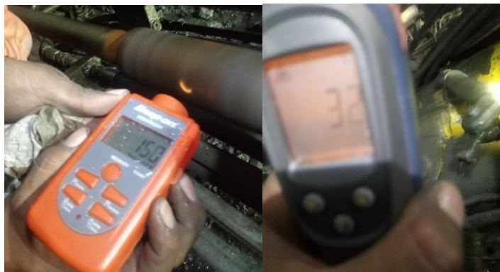
Figura 35. Medición de las rpm y temperatura de la columna
