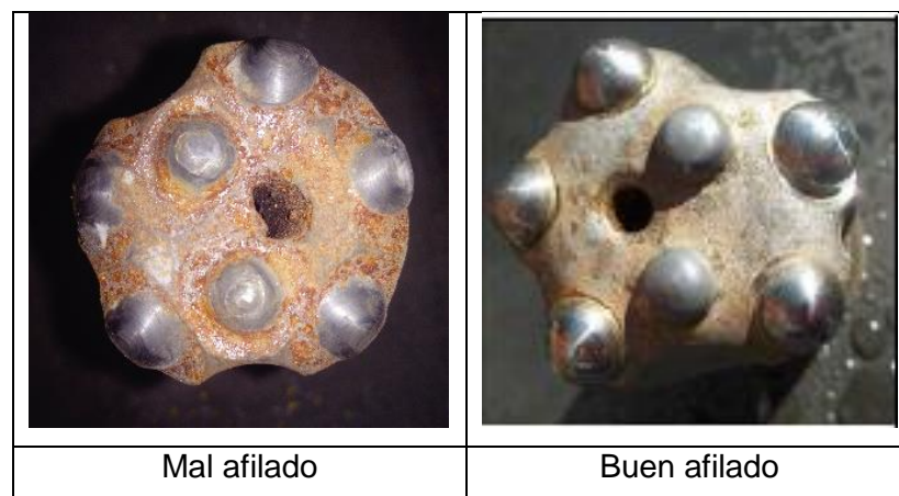
Figura 30. Mal / buen afilado
