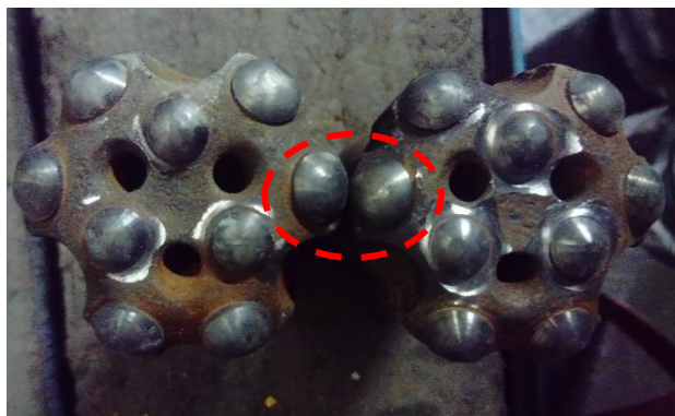
Figura 51. Choque entre insertos
