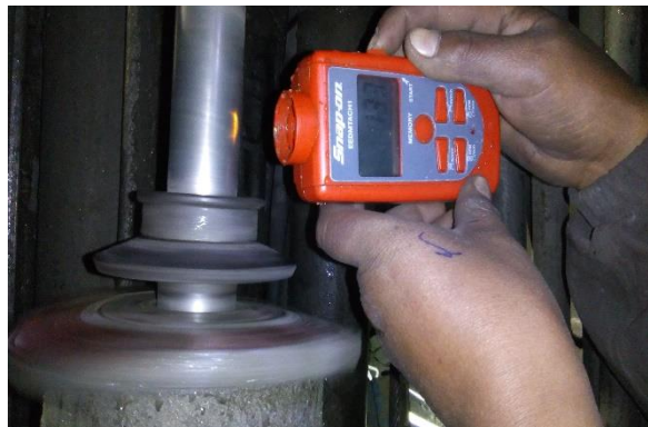
Figura 47. RPM muy bajo (133 rpm)
