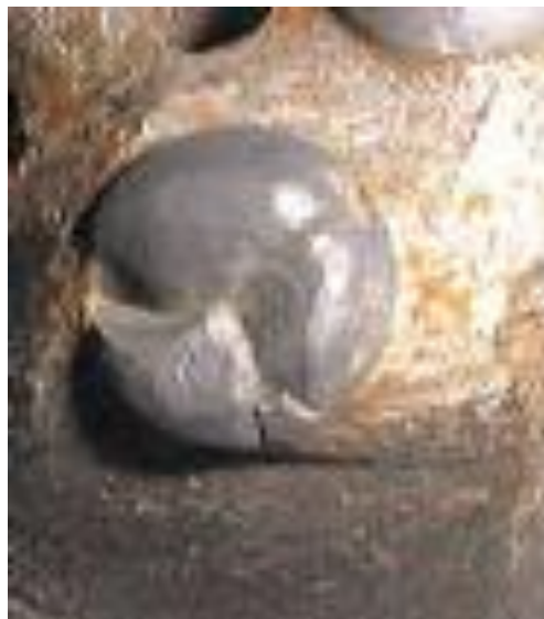
Figura 9. Daños en los botones (Insertos)
