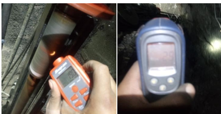
Figura 37. Medición de las rpm y temperatura de la columna
