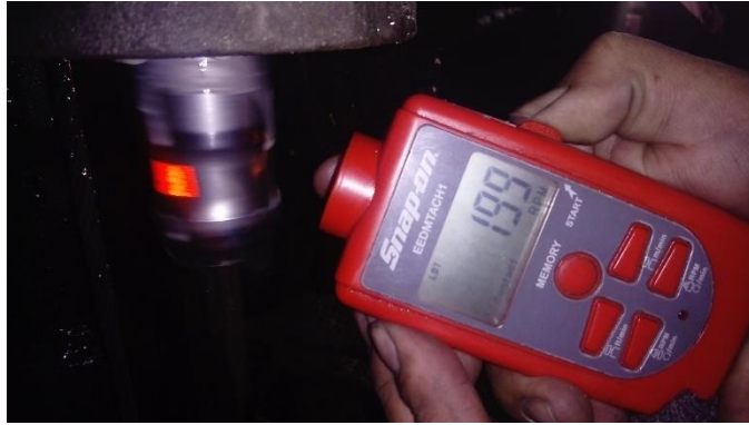
Figura 46. Medición de las rpm
