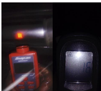
Figura 41. Medición de las rpm y temperatura de la columna
