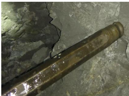
Figura 66. Barra rota a la altura de la rosca r32
