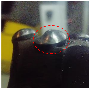
Figura 26. Deformación del inserto por centralización incorrecto
